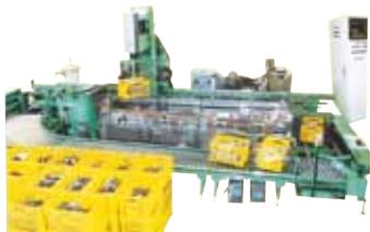
上下左右揺動洗浄と遠心回転温風乾燥を組み合わせた全自動タイプ(排水処理装置内蔵)
