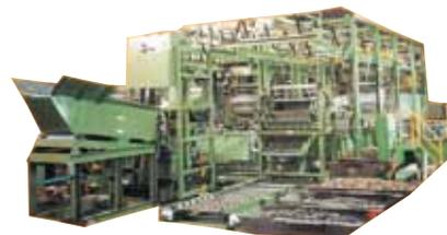
全自動化成処理装置(投入・取出し全自動回転式)
