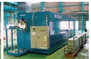
【実証テスト機】7mまでの長尺ワーク用自動臨界真空洗浄乾燥機
