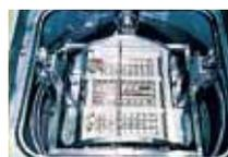
真空洗浄槽内部(回転バスケット方式)
