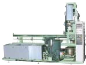
上下左右揺動洗浄と遠心回転温風乾燥を組み合わせた全自動タイプ
