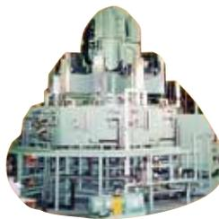
上下左右揺動洗浄と遠心回転温風乾燥を組み合わせた円周式全自動タイプ
