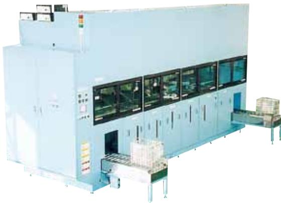
全自動6槽式(2型) バスケットサイズ:400x300x300H(mm)
