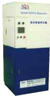
新型：真空水加熱式真空蒸留再生器
