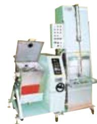
上下左右揺動洗浄機(手動) 遠心温風回転乾燥機(手動)
