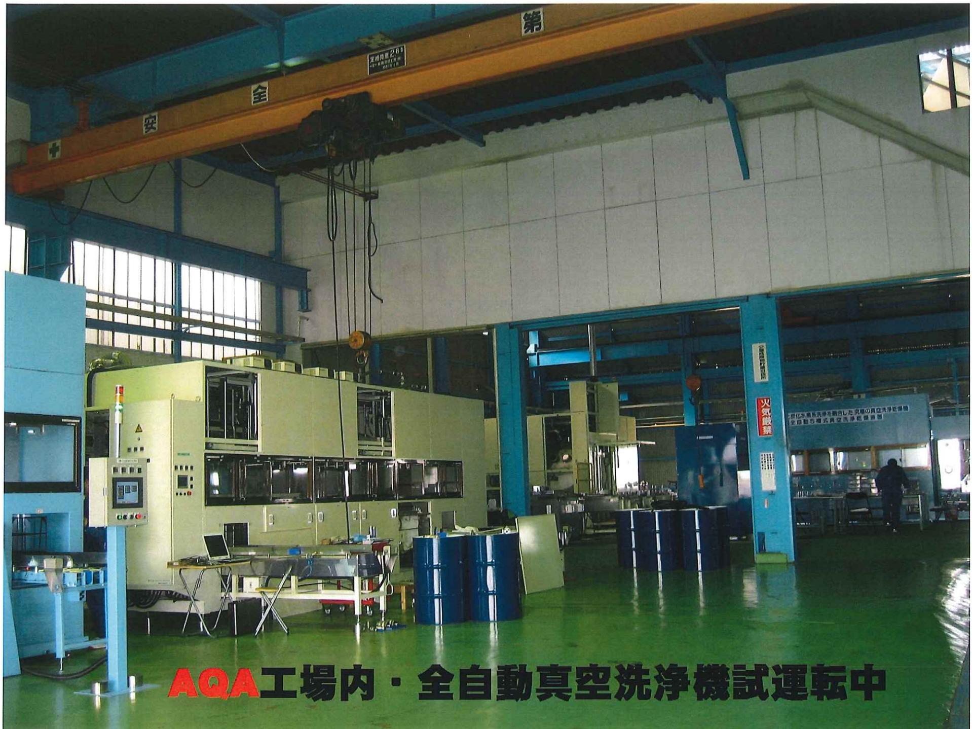
AQA工場内・全自動真空洗浄機試運転中
