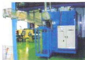
长达7m的长尺寸工件用自动临界真空清洗干燥机
