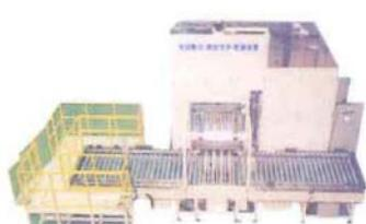
1槽式全自动真空清洗干燥机 1槽式全自动真空清洗干燥机 (热处理部件用) 1槽式全自动真空清洗干燥机 (附自动搬运)
