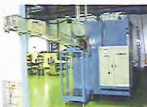
7 mまでの長尺ワーク用自動臨界真空洗浄乾燥機 (経産省・平成13年度創造研究開発補助金活用)
